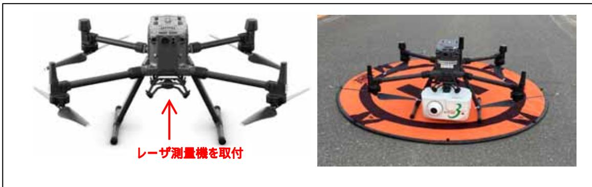
UAV レーザ測量機（例）
